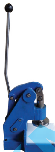
Станок для вырубki заготовок для пуговиц
